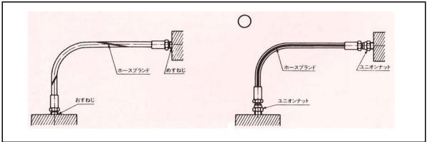
③ホースは金具付近から曲げないで下さい。ホースの曲げ半径は最小曲げ半径以上でお使い下さい。ホースを極端に曲げて使用すると早期疲労の原因となります。
