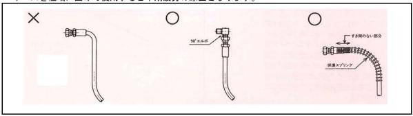
④ねじれや急激な曲げの避けられない場合には、スイベルジョイントを用いて、ホースのねじれや急激な曲げを防ぐようにして下さい。
