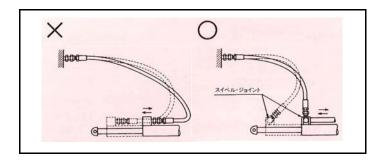
⑤ホースを配管する場合の曲げ半径は 必ずホース圧力が加わった時の位置 で測定して下さい。
